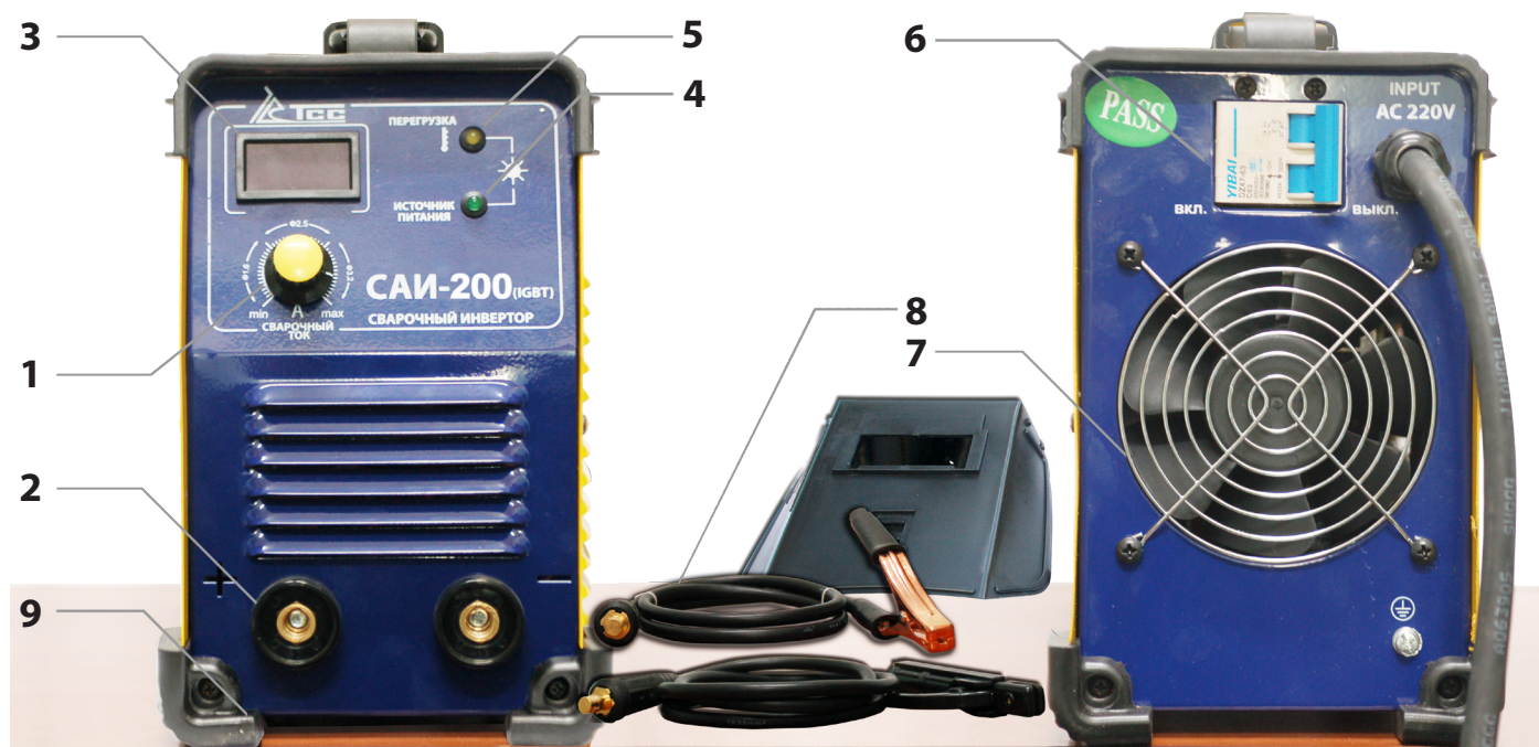
1 - регулировка сварочного тока; 2 - выводы для подключения кабеля; 3 - цифровой дисплей; 4 - индикатор сети; 5 - индикатор перегрузки; 6 - автомат защиты сети; 7 - вентилятор; 8 - кабель; 9 - прорезиненные углы.
